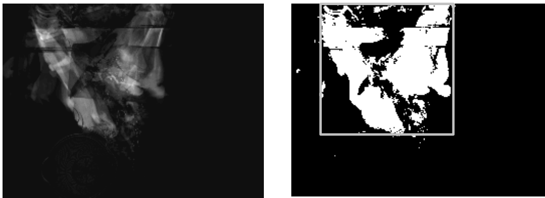
図 4: 作業領域特徴抽出に用いるフレーム間差分の加重平均画像 (左) と矩形領域を重畳した、左の画像の二値化画像 (右)
